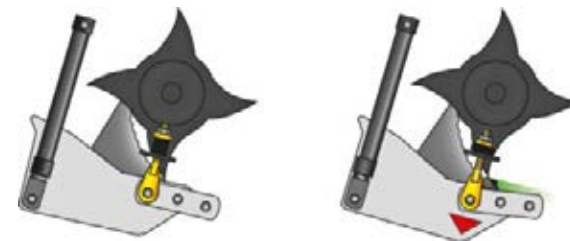
FlexControl-aflastningssystemet hindrer blokeringer.
