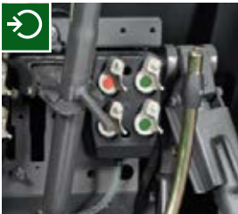
Både DUDK- og UDK-koblinger giver mulighed for tilkobling af hydraulikventilerne under tryk, og det gør det nemt at montere og afmontere redskaber. De selvlukkende ventilkapper giver sikker beskyttelse mod forurening fra snavs og vand.
