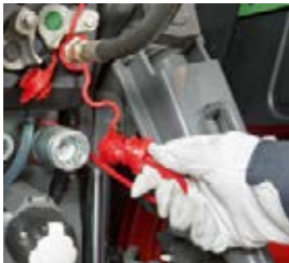
Power Beyond-tryk- og styreslange til fuld hydraulisk kraftoverførsel.
