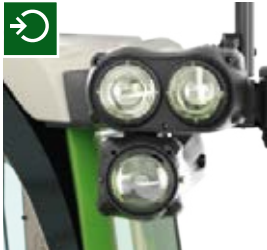
Tværbommene til de forreste arbejdslygter forhindrer effektivt skygger.
