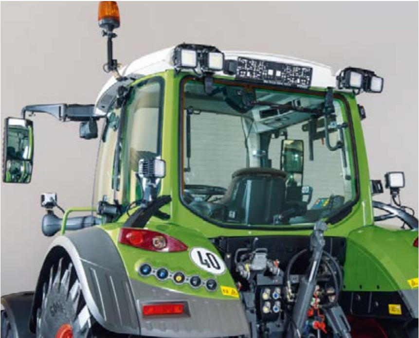
Hele lyskonceptet med op til seks arbejdslygter alene bagud giver fremragende oplysning for sikkert og komfortabelt arbejde, også når det er mørkt. De, der har brug for ekstra kraftigt lys, og som også gerne vil spare strøm, kan vælge Fendt 300 Vario med LED-arbejdslygter.
