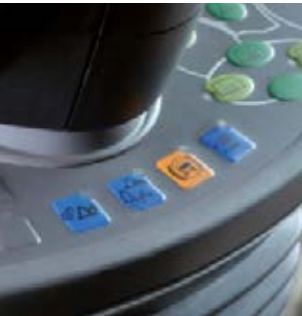
Membrantastatur til redskabslås og dæmpningsaktivering.
