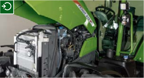
Brændstofforfilteret med termostatventil gør traktoren driftssikker, også ved meget lave temperaturer et godt stykke under nulpunktet. Køleren og filteret er anbragt med henblik på nem vedligeholdelse.
