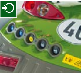
Den bageste lift og den ene glideventil kan styres fra en af bagskærmene.
