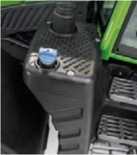
Påfyldningsstudsene til diesel og AdBlue er placeret på samme side af traktoren, så de er lette at nå fra jorden.
