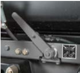
Trækkarmene kan blokeres med låseven-tilen på bageste lift.
