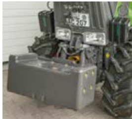
□ Frontvægten giver en bedre effektoverførsel til forakslen.
