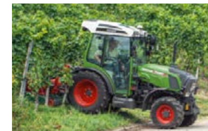
PTO'en arbejder uafhængigt af kørehastigheden på vejen. Du kan f.eks. køre langsomt med en ukrudtsharve i tæt, ikke skåret afgrøde og køre hurtigere og trinløst uden at skifte gear eller afbryde i ikke så tætte afgrøder.
