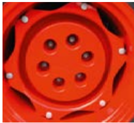
□ Ekstra hjulvægte øger bagakslens trækraft.
