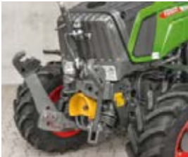
I P-varianten er løftekapaciteten på frontliften 2540 daN.
