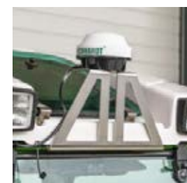
Positionsbaseret GPS-styresystem giver en nøjagtighed ned til 2 cm i Fendt 200 V/F/P Vario.
