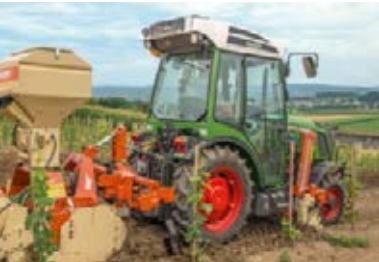
Mellemakselmonteringen giver effektiv anvendelse af fleksible redskabskombinationer.
