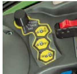
Praktisk PTO-komfortkontakt med automatisk funktion i armlænet.
