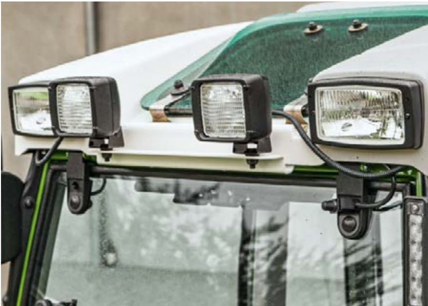
□ Der kan endvidere monteres to arbejdslygter foran på modellen uden forlygter.
