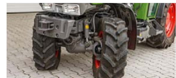
Med VarioActive kan du dreje til fuldt styreudslag med én drejning.
