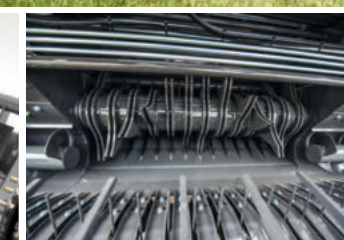
XtraCut13 Rotor (Afstand på fingerpar: 90 mm) - Uden cutter (standard) - Med cutter: op til 13 knive
