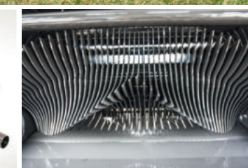
XtraCut25 Rotor - Med skæreværk: op til 25 knive
