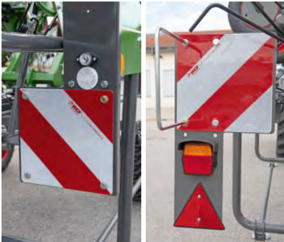
For at øge sikkerheden på vejen har tilkoblede Lotus-modeller som standard ekstra brede advarselsskilte og ekstra belysning.
