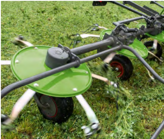
Store dæk på alle rotoréer giver fantastisk afgrødeindføring og jordfølgning.
