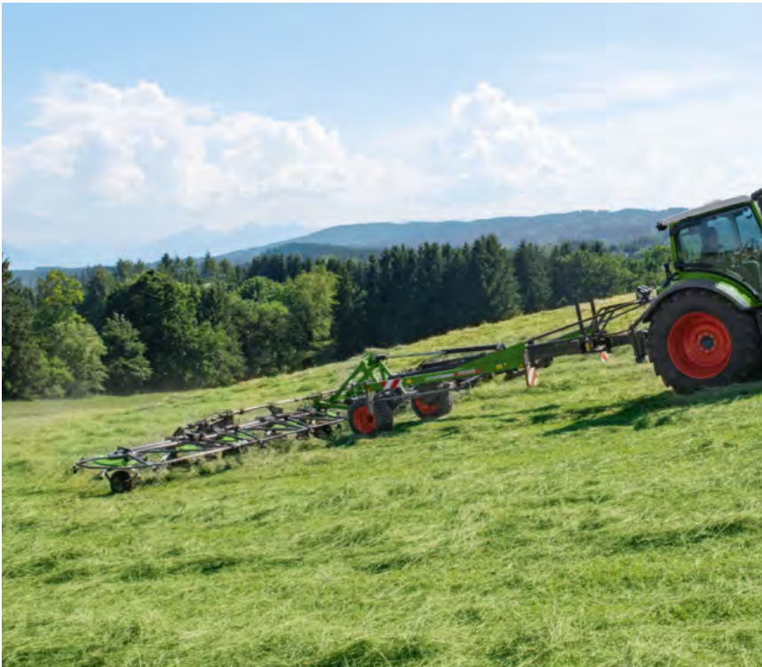
Fordelt i hele arbejdsbredden er der adskillige drejeled mellem rotoréerne, hvilket sikrer, at de følger jorden individuelt. Ringe slitage og rent foder med garanti.
