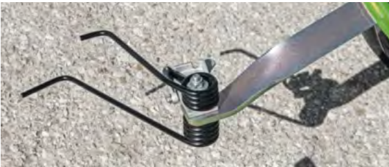
Tændernes særlige fastgørelse med justerbare vinkel betyder, at du let kan skifte til kantspredning eller natteskår, samtidig med at du undgår at tabe tænderne.
