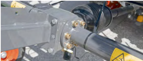
Overbelastningssikringen på hoveddrivakslen øger driftssikkerheden og gør Lotus rivernes drivlinje meget holdbar.
