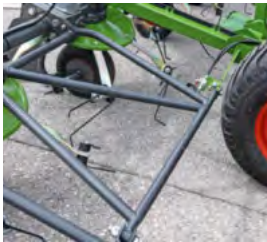
De trukne vendere har en ekstra gitterramme, der giver optimal stabilitet, både til beskyttelse og til at forstærke hovedrammen i hele maskinens bredde.
