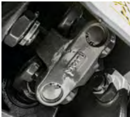
De vedligeholdelsesfrie, dobbelte kardanled sikrer direkte kraftoverførsel og betyder, at venderen også kan dreje i transportposition.
