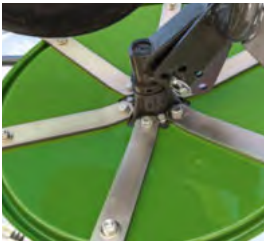
Store rotorplader sikrer høje tandhastigheder trods lav rotorhastighed.
