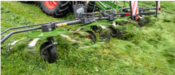
Antiviklesystemet forhindrer afgrøde i at vikle sig rundt om hjulakseléerne.
