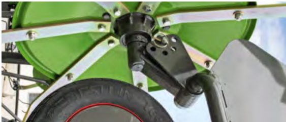
Du skal bare flytte en enkelt bolt for at justere spredvinkelpositionen. Du kan vælge mellem 5 indstillinger fra 10° til 17° – præcist tilpasset til dine behov, hver gang.
