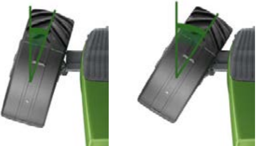
Ilma VarioActive-aktiivvõimendusega 1 pööre = 23,6°
