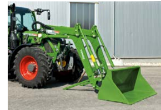
Fendt Cargo Lock tagab kiire ja lihtsa paigaldamise ja eemaldamise. Kõik hüdrovoolikud ja elektrijuhtmed ühendatakse kiirliitmiku abil – esilaaduri poolel saab ühendada isegi rõhu all olevaid voolikuid.
