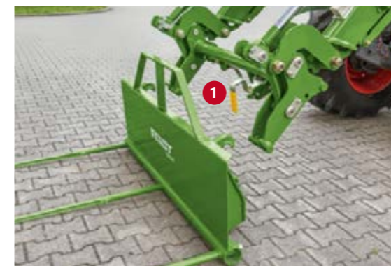
Tööorgan vabastatakse mugavalt ühe käega kiirkinnitusraami asuva hoova (1) abil. Paigaldamisel saab tööagregaati täielikult taha kallutades automaatselt lukustada.
