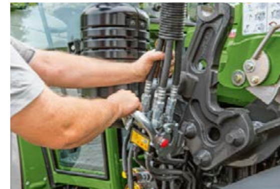
Tänu uuele Fendt Cargo-Lockile on esilaaduri paigaldamine ja eemaldamine kiire ja lihtne. Kiirliitmiku kasutamine säästab ka aega. See võimaldab kõiki hüdrovoolikuid ühendada vaid ühte kätt kasutades.
