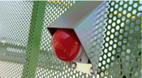
Lisavarustusena saadaolevat veosekasti täitumise heliindikaatorit juhib tagaluugil paiknev tasemeandur.
