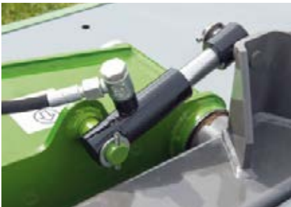
Õõtsutsumisleevendi silinder stabiliseerib niidukit põlluotstes ja teedel.
