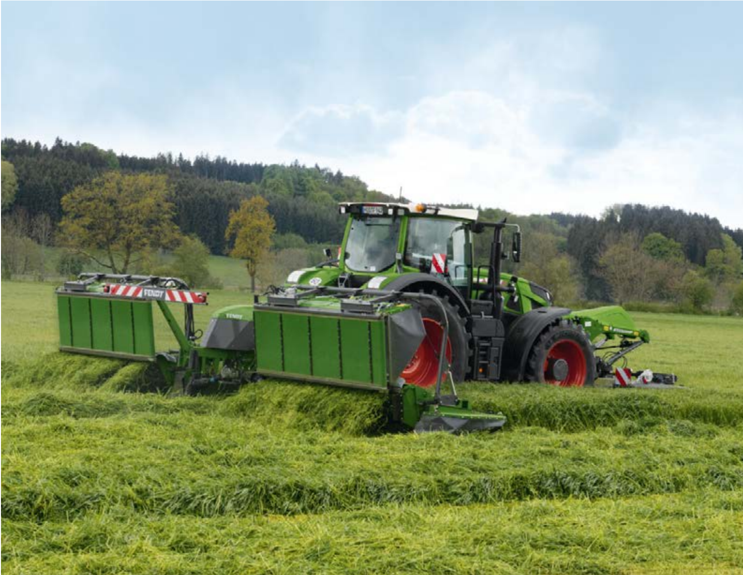
Konveierid saab üles klappida ja rohumassi kogu töölaiusele laiaili puistata ühe klahvilevajutusega terminalil.
