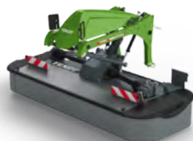
Vedava 3D ühendusraamiga esiniidukid Optimaalne kasutamiseks niidukombinatsioonis Töölaius 3,10 – 3,60 m
