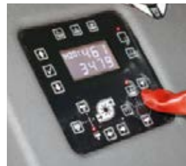
■ OptiFlow juhtimiskeskus: kemikaalidosaatorei kõrvale paigutatuna saab sellel juhtida segamisseadme ja lahusepaagi täitmise ajal täitmise kõiki funktsioone.
