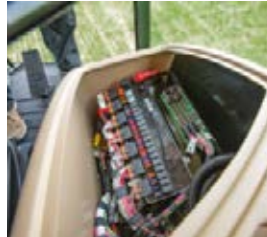
■ Kergesti juurdepääsetav tsentraalne elektrisüsteemi lülituskeskus koos FENDIAS diagnostikahendustega
