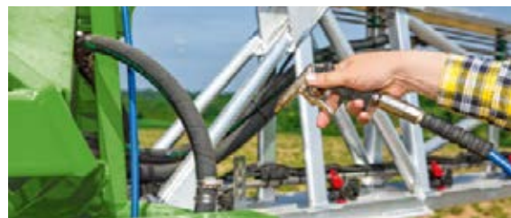
□ Lisavarustusse kuuluv kiiret puhastamist võimaldav suruõhupüstol paigaldatakse poomile
