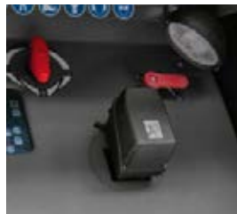
■ OptiFlow juhtimiskeskus: kemikaalidosaatorei kõrvale paigutatuna saab sellel juhtida segamisseadme ja lahusepaagi täitmise ajal täitmise kõiki funktsioone.
