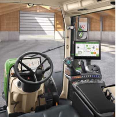
Profi+ Setting 2 - 3L-Joystick - 1 klahvipaar (lineaarmoodul) hüdroväljavõtete juhtimiseks - 12" terminal
