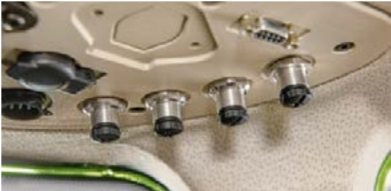
Kaamera ühendused Kabiinilaes asuval 4 kaameraühendusel (2 digitaalset, 2 analoogset) on terminalile edastatava pildi detailide eriti kõrge lahutusvõime.
