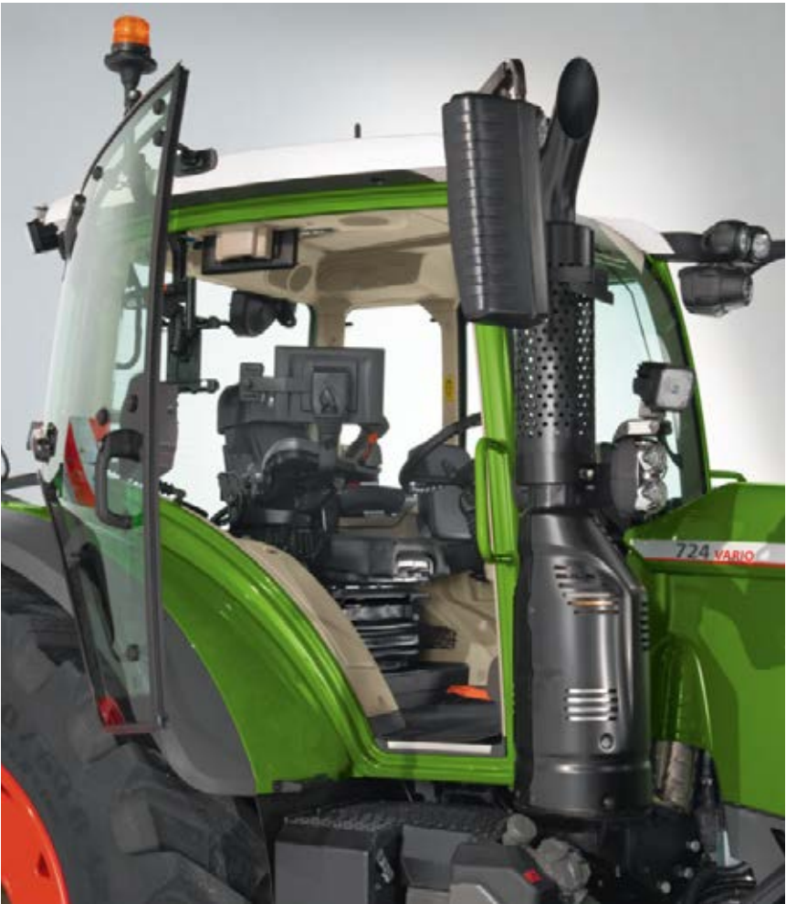
Kabiiniversioonid - Te saate valida 3 variandi vahel: VisioPlus panoraamkabiin: mitteavatav esiklaas ja ilma ukseta kabiini paremal küljel; VisioPlus panoraamvaatega kabiin + uks paremal: avatav parem uks, mitteavatav esiklaas; VisioPlus standardkabiin: uks paremal ja avatav esiklaas.
