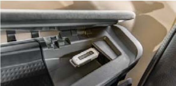
Paindlik andmeedastus Põllundmete importimiseks saab lisaks Bluetoothile ja mobiilvõrgule kasutada käetoes asuvat nelja USB porti. Neid porte saab kasutada ka tahvelarvuti või nutitelefonide laadimiseks.
