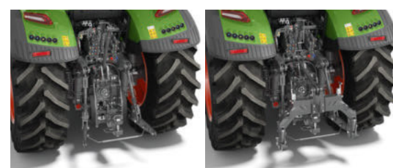
Tagumine ripphaakeseadis koos kuulotstega ja RubBlock ühendusplokkidega
