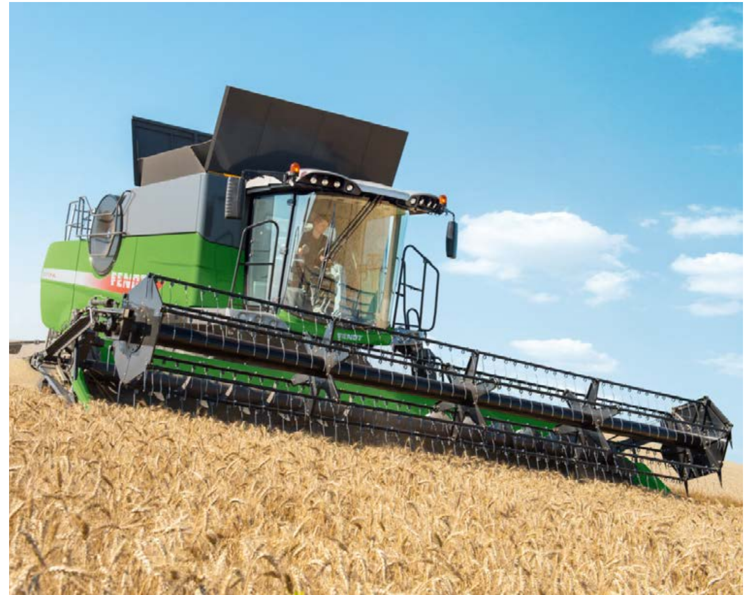
El sistema Constant Flow controla automáticamente la velocidad de avance de las cosechadoras Fendt en función de la carga de cultivo.
