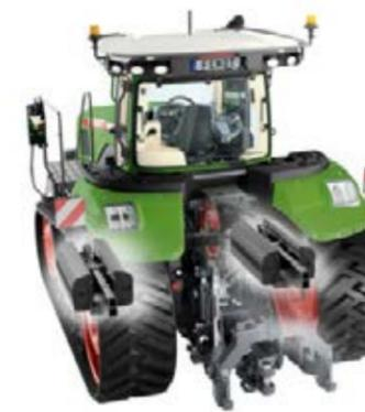
2.690 kg: 64 contrapesos en el interior y el exterior del chasis de rodadura (32 por banda de rodadura)
