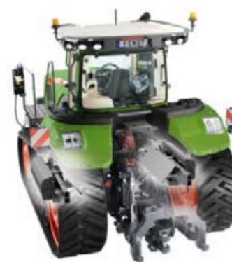
1.345 kg: 32 contrapesos en el exterior del chasis de rodadura (16 por banda de rodadura); protector anti-suciedad interno
