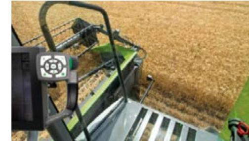
Excelente visibilidad del área de descarga para una descarga rápida de hasta 105 L./seg.
