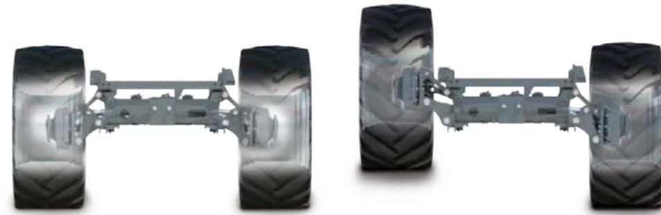
Cambio sencillo entre el modo de trabajo y de transporte con el sistema ParaLevel, que compensa pendientes de hasta el 20%.
