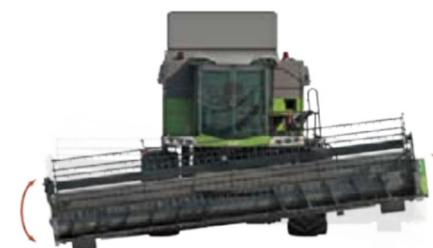
El control del cabezal AutoLevel estándar garantiza una altura de corte constante en toda su anchura.
