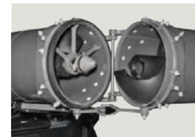
El gran diámetro del sinfín de descarga combina bajas velocidades con un alto rendimiento. Esto garantiza la calidad del grano.
