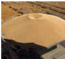
Volúmenes de hasta 17.100 L. del Streamer 210 se descargan en aprox. 81 segundos.
