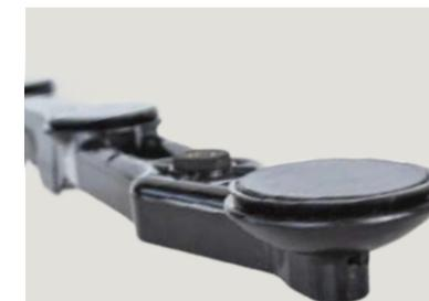
Los sensores de pérdidas al final del cajón de cribas ayudan al operador a ajustar la máquina en la mejor configuración posible, registrando el producto que cae al suelo mediante la presión y la acústica.
