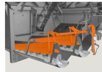
Las trampillas de cierre situadas sobre los sinfines en el fondo del tanque de grano controlan la velocidad de descarga en cinco posiciones.
