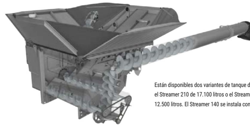
Están disponibles dos variantes de tanque de grano: el Streamer 210 de 17.100 litros o el Streamer 140 de 12.500 litros. El Streamer 140 se instala con ParaLevel.
