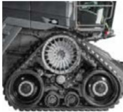
El mecanismo de orugas TrakRide minimiza la presión sobre el terreno.
