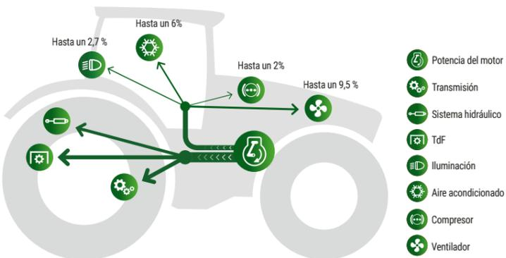
El nuevo ventilador Viscronic con control digital se adapta con una gran sensibilidad a los requisitos de refrigeración reales. Esto ahorra hasta un 1,4% de combustible y permite un funcionamiento más silencioso que un ventilador con control convencional. También reduce las reparaciones y aumenta los intervalos de servicio incluso en entornos con polvo.
