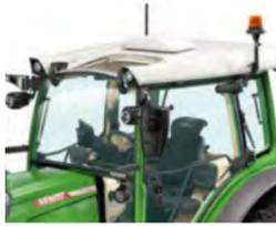
El receptor Fendt Guide está muy bien protegido e integrado totalmente en el diseño del techo. Sin piezas que sobresalgan ni cables guiados externamente, esta tecnología presenta una protección óptima contra ramas colgantes e incluso robo.
