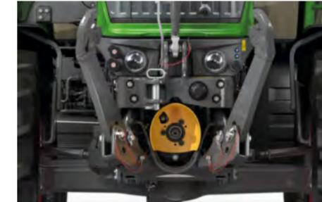
Los acoplamientos hidráulicos en la parte trasera están perfectamente alineados y codificados por colores. Los tapones antipolvo se cierran solos. Las conexiones están desplazadas para un fácil acoplamiento y, además, se desacoplan bajo presión.
