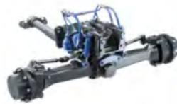
El sistema autonivelante integrado de la suspensión del eje delantero garantiza un confort constante de conducción y trabajo con cualquier carga. La función de bloqueo asegura un guiado preciso de los aperos en el modo de cargador frontal, por ejemplo, al cargar palets.
