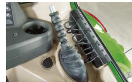
Fendt ofrece una solución inteligente para los cables que se extienden desde la parte trasera del tractor hasta el interior de la cabina. Los cables pueden tenderse perfectamente a través de la guía con independencia de la sección transversal. La luneta trasera puede cerrarse para que no entre polvo, suciedad, agua ni ruido.
