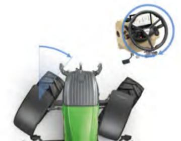
En las cabeceras o durante los trabajos con el cargador frontal puede beneficiarse de la dirección FendtActive\*, alcanzando el ángulo total de giro de las ruedas con un solo giro del volante. El sistema de dirección superpuesta no tiene límites hasta 8 km/h, mientras que el efecto de superposición es lineal entre 8 y 18 km/h.
