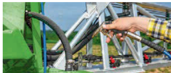
□ La pistola de aire comprimido opcional se halla al final de la barra de pulverización para una limpieza rápida.
