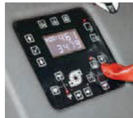
■ Centro de control OptiFlow: Dispuesto a lo largo del depósito incorporador para facilitar el control de todos los agitadores y funciones durante el proceso de llenado.
