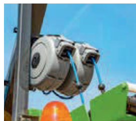
□ Práctica devanadera para limpiar el exterior de la máquina.
