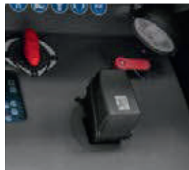
■ Centro de control OptiFlow: Dispuesto a lo largo del depósito incorporador para facilitar el control de todos los agitadores y funciones durante el proceso de llenado.
