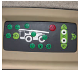
■ Interruptor individual o compartido para los faros de trabajo y el limpia-lavaparabrisas.
