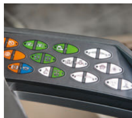
■ Teclado de membrana retroiluminado antideslumbrante, para un acceso fiable a todas las funciones en cualquier momento.
