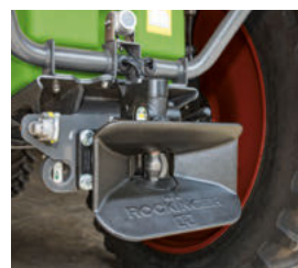
□ Enganche de remolque automático con freno y conexiones eléctricas.
