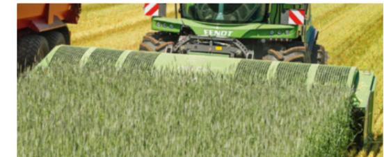
El robusto mecanismo de cabezal de corte directo está diseñado para cortes profundos sin pérdidas en los más dispares tipos de cultivos. En la cosecha de la biomasa, se produce el mejor ensilado con una mínimo porcentaje de suciedad.
