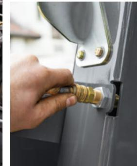
Tres tomas de aire comprimido integradas permiten limpiar en seco los componentes esenciales del vehículo directamente en el campo.
