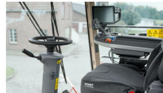
El canal de descarga puede girarse rápidamente de un lado al otro de la máquina con sólo pulsar un botón en la palanca multifunción.
