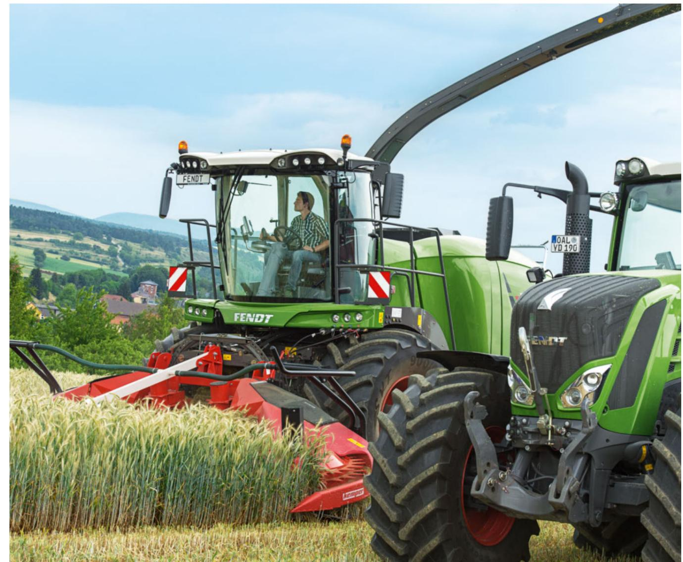
La combinación del sistema de guiado automático y el control automático de la productividad máxima disminuye la carga de trabajo del conductor, garantizando una óptima utilización de la picadora de forraje Fendt Katana y permitiendo al conductor trabajar en un ambiente relajado.
