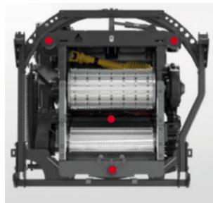
Bastidor oscilante en la posición central
