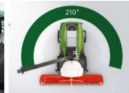
Incluso con una altura de descarga de hasta seis metros, el conductor tiene una visión completa del extremo del codo del canal de descarga. Opcionalmente, el canal de descarga puede prolongarse para permitir el llenado óptimo del vehículo de carga de manera óptima, incluso con cabezales anchos.
