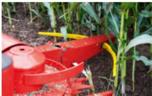
Gracias a los palpadores en los extremos del cabezal de maíz, la Katana trabaja con una exactitud de centímetros y en forma totalmente automática a través del cultivo.
