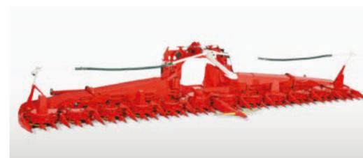
Con una anchura de trabajo de 9.000 mm, el 390plus es el más eficiente de todos los cabezales de corte de Katana.
