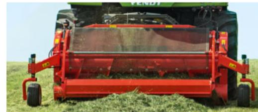
La unidad de transmisión continua del cabezal le permite ajustar la velocidad del pick-up para adaptarse con precisión a las condiciones de la cosecha y la velocidad de avance de la Fendt Katana.
