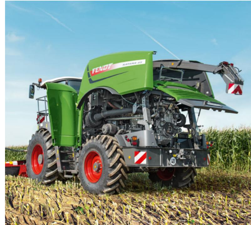
Los compartimentos de almacenamiento y baterías en la parte trasera del vehículo de fácil acceso ofrecen un amplio espacio, por ejemplo, suficiente para una caja de herramientas opcional.
