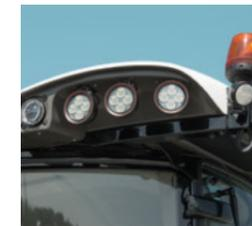
3 pares de faros de trabajo en el techo, luces delanteras en el techo, faros laterales y rotativo.
