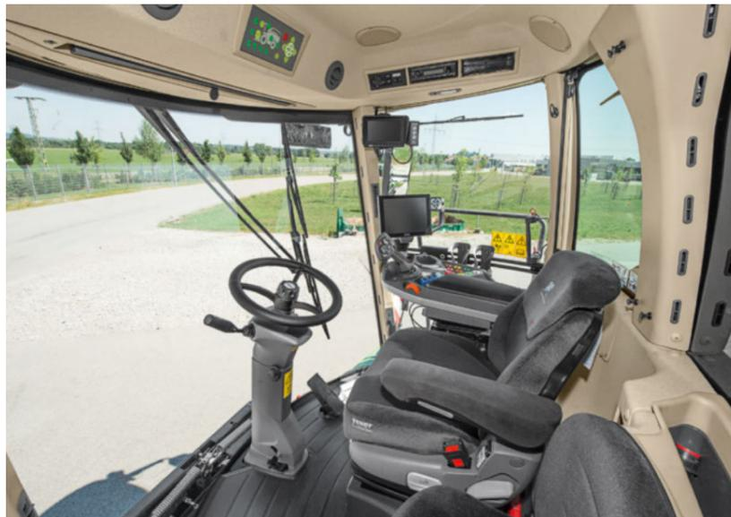
La cabina Visio5 está diseñada para una visibilidad óptima y ofrece una perfecta ergonomía y control en el lugar de trabajo. Gracias al contorno del techo realizado en forma especial, el conductor puede ver con comodidad la tapa del canal de descarga. El aire acondicionado y la calefacción garantizan un ambiente de trabajo agradable.
