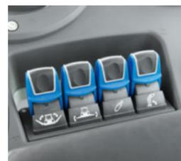
Funciones como la apertura/cierre del cabezal de maíz y las ruedas de soporte del pick-up, la inclinación del cabezal y la subida/bajada del canal de descarga se controlan cómodamente con los interruptores basculantes.
