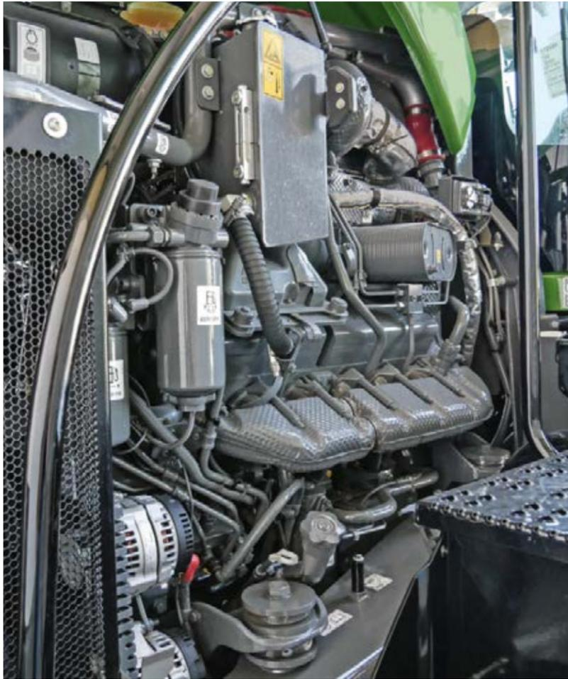
■ El motor de 12 cilindros de AGCO Power tiene un funcionamiento extraordinariamente suave y resulta fácil acceder al mismo para tareas de mantenimiento.
