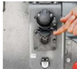
■ Hay una conexión de 12 V en la parte trasera para consumidores externos. La conexión ISOBUS establece conexión con los aperos.
