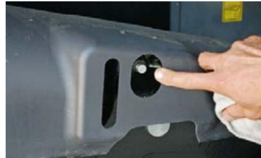
Las conexiones de presión para tensar las orugas son fácilmente accesibles.
