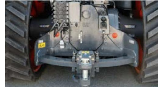
La barra de tiro, con oscilación hidráulica de hasta 28° a cada lado, controla perfectamente los aperos.
