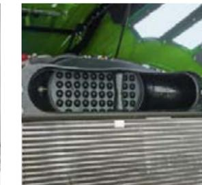
El filtro de aire con separación del polvo garantiza que el aire de entrada esté fresco y limpio.
