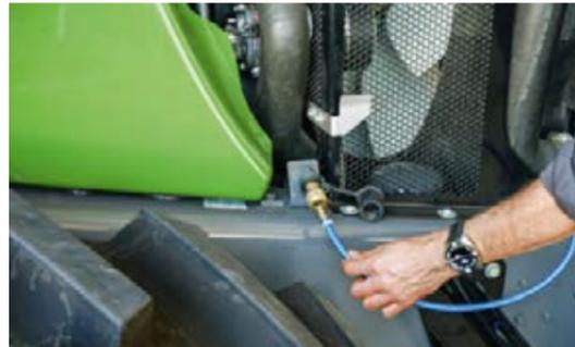
En la parte delantera hay una conexión de aire comprimido para limpiar el radiador.
