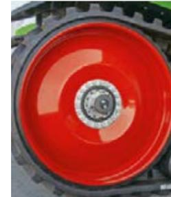
La rueda directriz es empujada contra la oruga mediante un cilindro tensor, manteniendo la tensión correspondiente.
