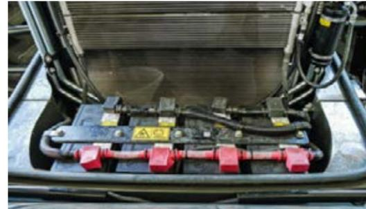
Cuatro baterías exentas de mantenimiento abastecen al Fendt 1100 MT.
