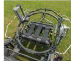
El anillo de encintado es guiado y accionado por rodillos de goma. Otros dos rodillos accionados hidráulicamente garantizan un guiado y tensado constantes del anillo.
