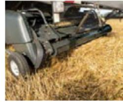
Tienen un amplio pick-up con cubierta deflectora y rodillo de presión para un flujo uniforme del material hacia la empacadora.
