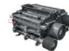
Las versiones completamente nuevas de cracker de rodillos de la Fendt Katana 650 incorporan enormes rodillos en el acondicionador con 300 mm de diámetro cada uno.
