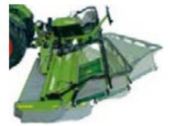
En caso necesario, el sistema de protección contra impactos único y patentado SafetySwing puede mover la combinación de segadoras hacia arriba y hacia la parte posterior hasta una altura de 1,5 metros.
