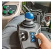
La palanca monomando en cruz eléctrica controla el cargador frontal con suma precisión. El tercer y cuarto circuito de control puede manejarse sin cambiar de mano utilizando los pulsadores de la palanca monomando en cruz.
