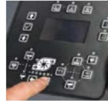
La consola de control OptiFlow permite controlar fácilmente los pesticidas aplicados.
