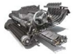
El rotor de corte en forma de V trabaja a velocidades de hasta 120 rpm para proporcionar una alta frecuencia de corte y obtener la mejor calidad de corte. El bastidor inferior donde se alojan las cuchillas de corte puede extraerse desde el lado izquierdo de la máquina para el reemplazo de las cuchillas.
