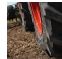
El dispositivo perfectamente integrado de regulación de presión de neumáticos VarioGrip regula la presión de los mismos entre 0,6 y 2,5 bares en pocos minutos.
