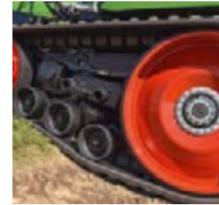
Los rodillos intermedios están suspendidos con ConstantGrip para no perder el contacto y transmitir la potencia de forma permanente.
