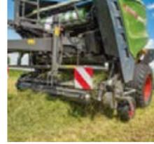
El Sistema EasyLoad permite añadir bobinas de malla en el menor tiempo posible. El sistema de atado con malla VarioNet trabaja con todas las anchuras de malla estándar entre 1,18 y 1,35 m.
