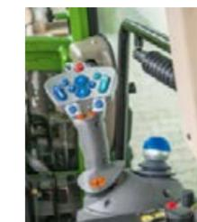
El operador tiene todo bajo control gracias a los pulsadores del cómodo joystick multifunción. Elevador hidráulico trasero, válvulas de control, control de cruce y memoria de velocidad. El reposabrazos se pliega para dejar a la vista un mando giratorio que puede utilizarse para seleccionar la asignación de los pulsadores del joystick multifunción.
