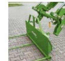
El bloqueo automático de implementos proporciona el máximo confort y seguridad al cambiar de implemento.
