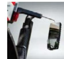
Los espejos retrovisores extensibles con ajuste eléctrico le permiten adaptarlos a diferentes anchuras de vehículo.
