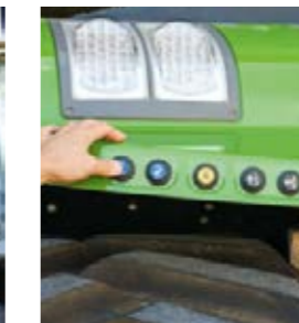
Puede utilizar el elevador trasero, la TdF y una unidad de control cómodamente desde los guardabarros traseros.
