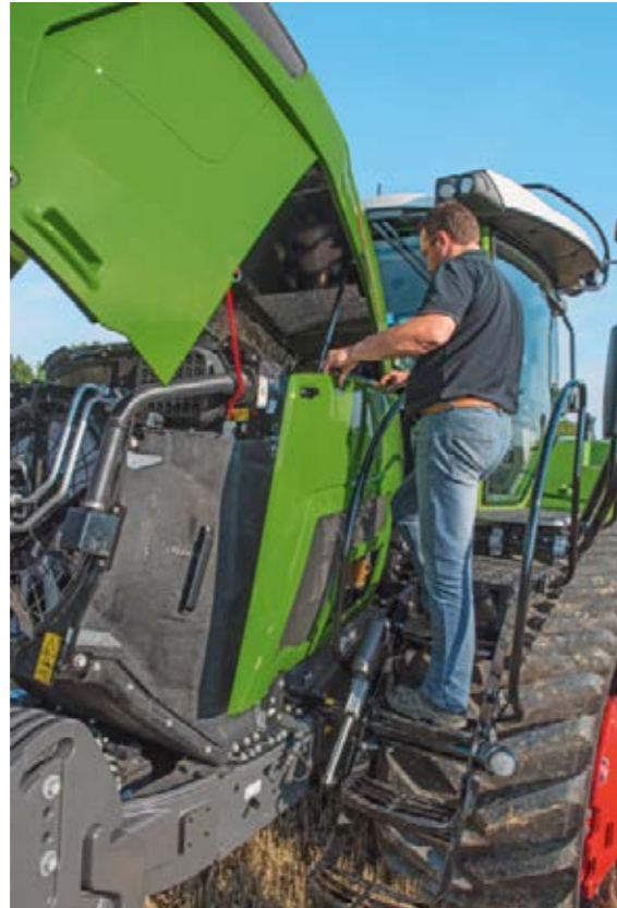
El compartimiento del motor es muy accesible, con paneles laterales extraíbles.
