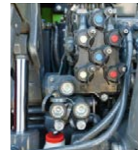
Las conexiones hidráulicas están marcadas en colores. Esto permite conectar los dispositivos con rapidez y seguridad.
