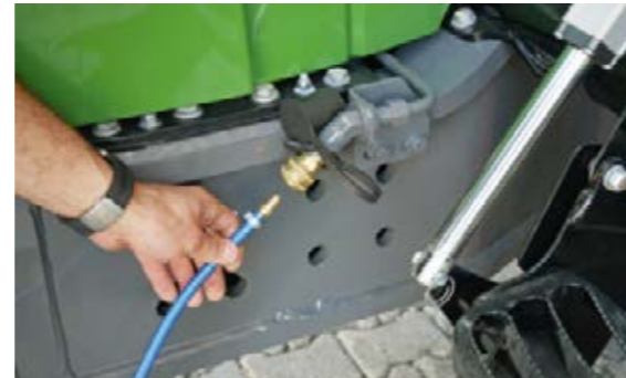
Hay una conexión de aire comprimido en la parte delantera de la máquina para limpiar con aire a presión el radiador.
