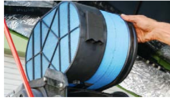
El filtro de aire es fácil de sustituir y cuenta con un sensor de suciedad que facilita información sobre el efecto del filtro.
