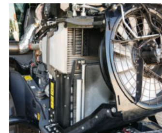
Un intercooler de gran tamaño con un intercambiador de calor como intercooler intermedio garantiza que el aire de entrada tenga la temperatura perfectamente controlada.
