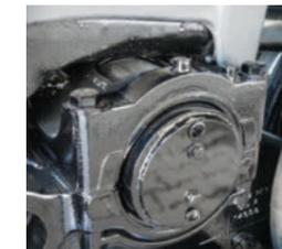
□ El sistema de ajuste de la anchura de vía hace que el Fendt 900 Vario MT pueda utilizarse perfectamente para cultivos en hileras.
