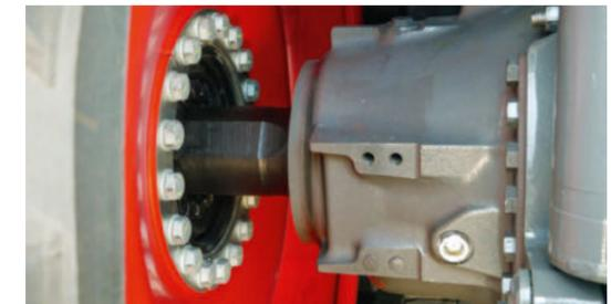
El resistente eje trasero se ha fabricado para ofrecer la vida útil más larga. El nivel de aceite interno se comprueba fácilmente a través de las mirillas de inspección.
