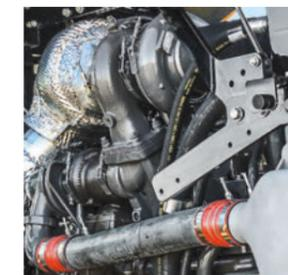
Dos turbocompresores con geometría fija y control electrónico de la válvula de descarga proporcionan un par enorme en toda la gama de velocidades.
