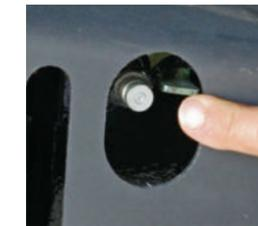
□ La presión para el pretensado de la oruga se ajusta cómodamente desde un lateral mediante una conexión.
