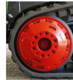
Las ruedas directrices delanteras pueden lastrarse con hasta 1.580 kg.
