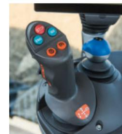
Puede utilizar el joystick multifunción (equipado de serie) para controlar la velocidad, los controles de cruceo, la memoria de revoluciones del motor y la gestión de cabezales.
