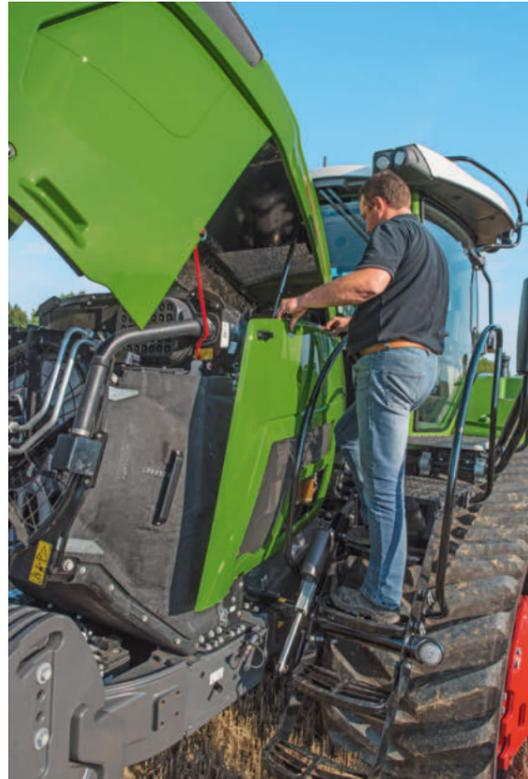
El compartimento del motor es muy accesible, con paneles laterales extraíbles.
