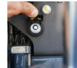
■ La conexión de 12 V en la parte trasera de la máquina abastece a los consumidores externos.
