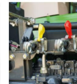
Los frenos neumáticos de doble circuito también actúan sobre el remolque cuando se acciona el freno de estacionamiento.
