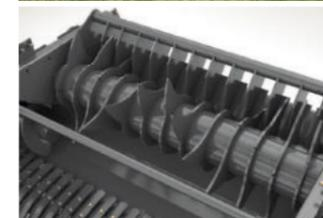
**Rotor de alimentación sin bastidor de corte**
