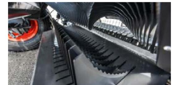
Los modelos Rotana 160VXtra y 180VXtra accionan hidráulicamente grupos de 0, 12, 13 y 25 cuchillas.
