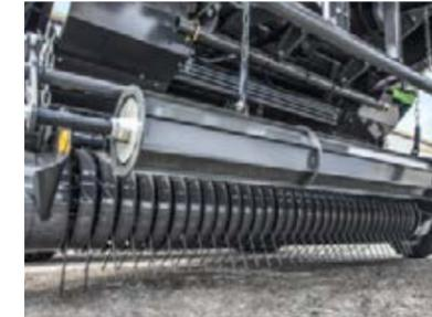
Gracias al pequeño espacio existente entre el pick-up y el rotor, el forraje se transfiere de forma suave y fiable. Y, gracias a la forma en V, la cámara de empacado se llena de forma uniforme, lo que, a su vez, da lugar a balas fuera de serie.
