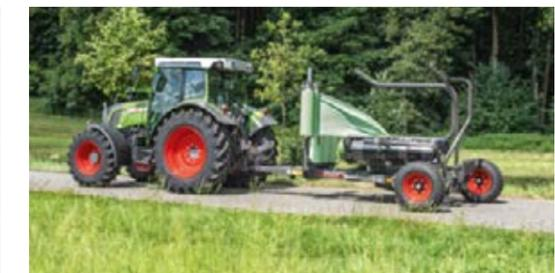
La Fendt Rollector encinta balas con un diámetro de entre 0,90 m y 1,30 m.
