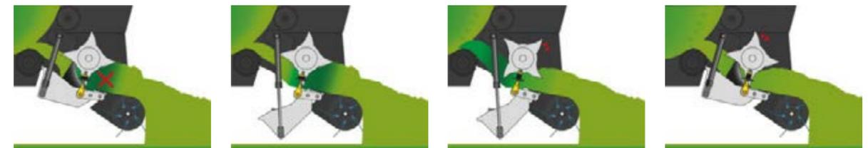
En el caso de producirse un bloqueo, la parte trasera de la base de corte desciende 500 mm.
