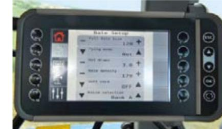
Gracias a ISOBUS, la empacadora se comunica de forma continua con los terminales ISOBUS integrados en el tractor, incluyendo el terminal Vario de Fendt.
