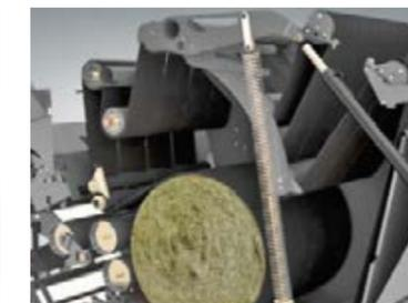
Los dos rodillos frontales que transportan las correas accionan la correa. Este doble bobinado de los rodillos significa que la rotación es totalmente fiable para cualquier tipo de paca.
