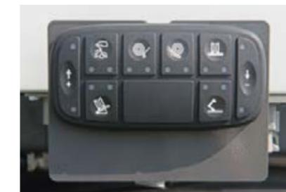
La roto/encintadora funciona de forma sumamente sencilla con el panel de mando trasero de la máquina para el funcionamiento manual.
