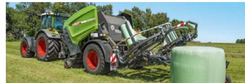
Con la descarga frontal, las balas quedan en posición vertical en el campo y se transportan con facilidad y rapidez.
