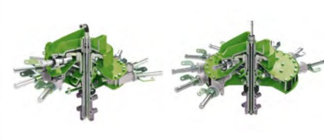
Los soportes de los brazos de púas pueden sustituirse individualmente sin desmontar la platina del rastrillo.
