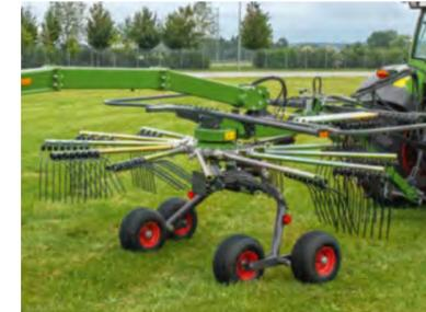
La inclinación horizontal de los rotores se ajusta fácilmente soltando el tornillo de sujeción y girando los tornillos de leva.
