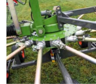
Accionamiento mediante engranaje cónico con un eje de piñón biselado dividido con rodamientos gemelos.
