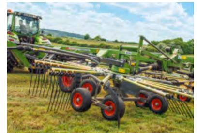
Al descender en las cabeceras, primero tocan el terreno las ruedas traseras y después las delanteras. En las elevaciones, los rotores se elevan primero por la parte delantera. Este Jet-Effect protege la cubierta vegetal.
