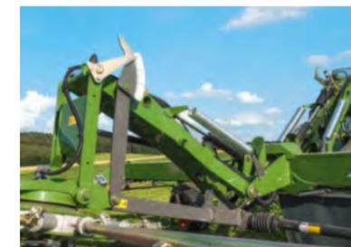
El ajuste hidráulico permite regular la anchura de trabajo cómodamente sin salir de la cabina del tractor. Su indicador de fácil lectura informa sobre la anchura de trabajo ajustada.
