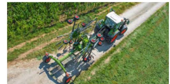
Los equipos Fendt Former son maniobrables y compactos en la posición de transporte. Esto significa que es fácil alcanzar una velocidad de transporte de 40 km/h.
