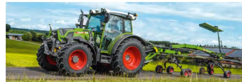
El amplio despeje al suelo se garantiza mediante la elevación paralela de los rotores gracias a un eje pórtico hidráulico.
