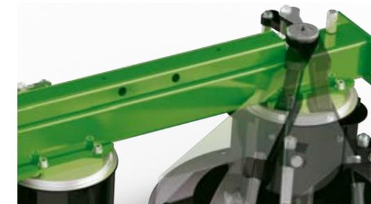
El soporte con perfil en U de la segadora Cutter FPV está diseñado para ofrecer la máxima durabilidad y no se ve afectado por picos de carga en los extremos.
