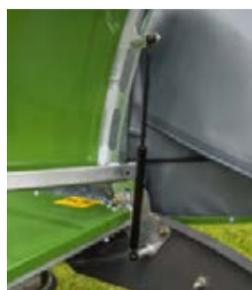
■ Las protecciones pueden girarse hacia arriba para labores de limpieza y mantenimiento y se mantienen en posición gracias a amortiguadores de presión de gas.
