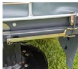
■ La herramienta especial para el cambio rápido de las cuchillas está siempre al alcance de la mano en la segadora.
