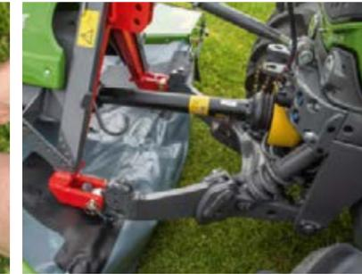
Es posible utilizar una palanca para ajustar manualmente la altura de hilera requerida sin necesidad de herramientas.
