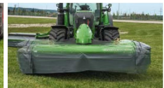
Las protecciones de suave funcionamiento que se giran hacia arriba marcan una gran diferencia en las labores de limpieza y mantenimiento. Todas las Fendt Cutter son fácilmente accesibles y la anchura de hilera puede ajustarse con poco esfuerzo.
