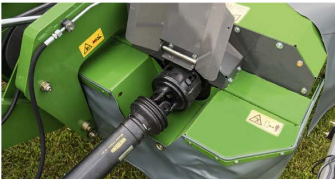
■ El eje de transmisión es rápidamente accesible y se lubrica con facilidad.
