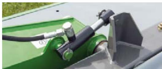
■ El cilindro hidráulico de suspensión estabiliza la segadora en las cabeceras y en carretera.
