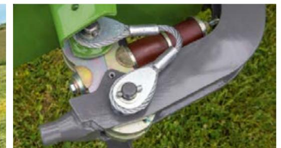
La generosa distancia respecto al suelo permite girar de forma rápida y segura en cabecera, y el cilindro hidráulico de suspensión en el brazo mantiene la segadora igualmente estable en cabecera.
