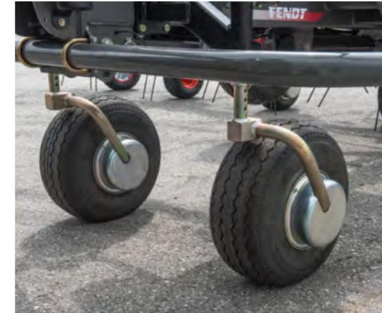
□ Las ruedas direccionales móviles opcionales optimizan el seguimiento del terreno y garantizan un rastrillado limpio y la protección de los pastos. (Fendt Twister 901 T)
