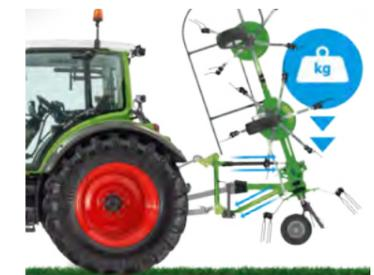
El sistema patentado de compresión tracción garantiza un óptimo seguimiento del terreno y un magnífico comportamiento de remolque gracias al punto de enganche bajo.
