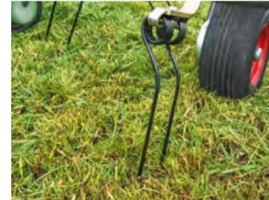
Los soportes de las púas tienen una superficie de contacto resistente a la torsión y extraordinariamente ancha en la placa de rotor.
