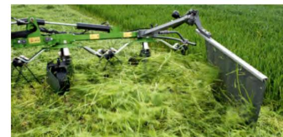
En el modelo superior de la serie, el Twister 11010 DN, el esparcido marginal se efectúa con una lona opcional que se pliega con un sistema hidráulico.
