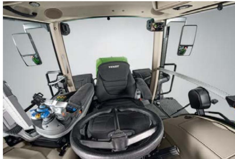
Para utilizar el tractor con el puesto de conductor reversible, basta con girar 180° la plataforma del operador. Puede utilizar todos los controles en el modo de retroceso con la misma facilidad que en el de avance. El acompañante tampoco tiene por qué renunciar a su asiento confort si se hace uso de esta función.
