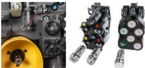
En la parte delantera, el Fendt 900 Vario ofrece la opción de un elevador hidráulico integrado con control de posición y descarga. También puede tener hasta dos válvulas delanteras con un caudal de hasta 100 l/min, una TdF delantera y un conector ISOBUS.
