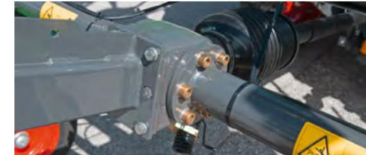
La protección frente a sobrecargas en el eje de transmisión principal mejora la fiabilidad de funcionamiento y confiere una excepcional durabilidad al tren de tracción del henificador Lotus.
