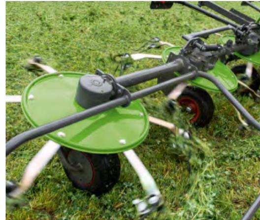
Voluminosos neumáticos en cada rotor para una excelente alimentación de forraje y ajuste al terreno.
