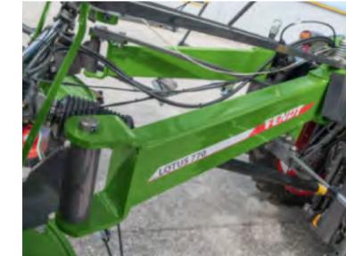
Los rotores se pliegan hidráulicamente y se aseguran de forma mecánica para el transporte.
