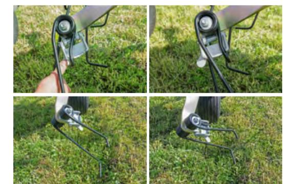
Un sencillo ajuste de las púas en el rotor exterior activa el mecanismo de procesamiento marginal. Esto coloca las púas en la posición más interior para un borde del campo limpio y una perfecta distribución del material segado.
