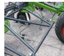
Los henificadores arrastrados incorporan un bastidor adicional en forma de rejilla para obtener la máxima estabilidad, como protección y refuerzo del bastidor principal en toda la anchura de la máquina.
