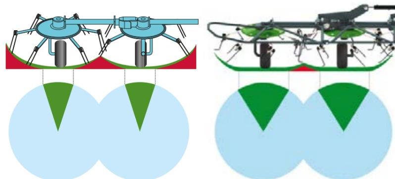
Las púas Fendt Performance ejercen un movimiento de arrastre – pero, con su solución de gancho y su gran flexibilidad, se deslizan por el suelo sin dañar la cubierta vegetal. Cuentan con un enorme margen de recogida en comparación con las púas convencionales, ofreciendo una mayor cobertura de superficie.
