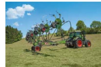
Los rotores se colocan sobre el bastidor para el transporte por carretera. Esto protege las articulaciones giratorias al no recibir ningún tipo de tensión cuando están plegadas. La posición especial de transporte, con los rotores alineados en fila, garantiza que incluso los modelos Lotus de mayor tamaño sean suficientemente compactos para transportarlos.
