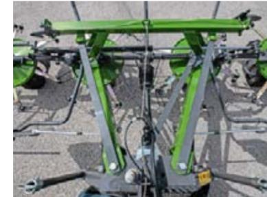
El bastidor de enganche de tres puntos con casquillos de cojinetes de tres materiales en las bisagras abatibles destaca por su durabilidad y fácil mantenimiento.
