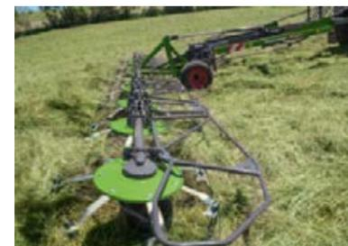
Las grandes ruedas de transporte en movimiento de avance aseguran un funcionamiento muy silencioso con una profundidad de trabajo constante.
