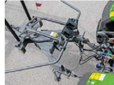
Punto pivotante desplazado hacia detrás y menor longitud del bastidor para una extraordinaria maniobrabilidad – a pesar de la mayor anchura de trabajo.
