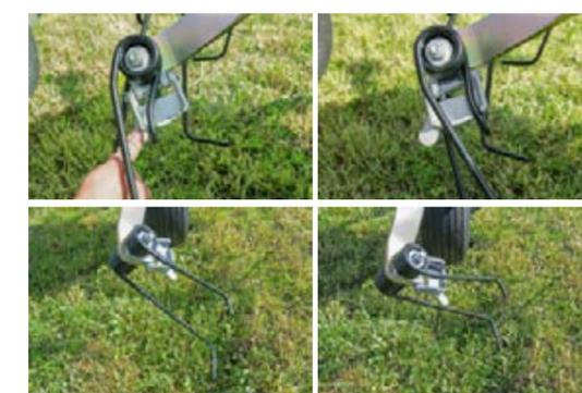
Un sencillo ajuste de las púas en el rotor exterior activa el mecanismo de procesamiento marginal. Esto coloca las púas en la posición más interior para un borde del campo limpio y una perfecta distribución del material segado.
