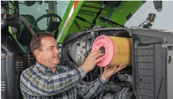
El capó abatible y los paneles laterales extraíbles ofrecen un excelente acceso al compartimiento del motor. Esto le permite retirar el filtro de aire de forma rápida y sencilla.
