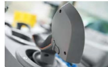
Los rodillos de control de presión del Pick-up son fáciles de operar mediante el interruptor basculante situado en la parte posterior de la palanca multifunción. Esto le permite pivotar el bastidor oscilante de forma manual en las tareas con maíz y activar el indicador en el modo carretera.
