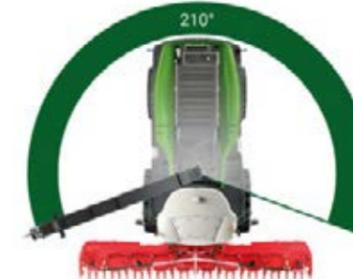
Incluso con una altura de descarga de más de seis metros, el conductor tiene una visión completa del extremo del codo del canal de descarga. Opcionalmente, el canal de descarga puede prolongarse para permitir el llenado óptimo del vehículo de carga de manera óptima, incluso con cabezales anchos.
