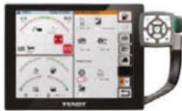
Con el Control de la Productividad Máxima puede establecerse en el terminal la caída de vueltas de motor y la velocidad máxima de conducción, a fin de ajustar esta función de un modo automático a las condiciones existentes en el campo.
