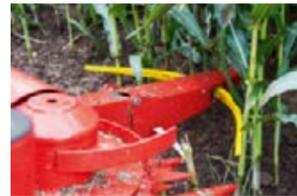
Gracias a los palpadores en los extremos del cabezal de maíz, la Katana trabaja con una exactitud de centímetros y en forma totalmente automática a través del cultivo.
