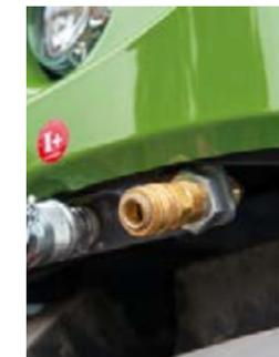
Tres tomas de aire comprimido integradas permiten limpiar en seco los componentes esenciales del vehículo directamente en el campo.
