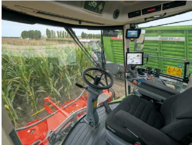
La cabina Visio5 está diseñada para una visibilidad óptima y ofrece una perfecta ergonomía y control en el lugar de trabajo. Gracias al contorno del techo realizado en forma especial, el conductor puede ver con comodidad la tapa del canal de descarga. El aire acondicionado y la calefacción garantizan un ambiente de trabajo agradable.
