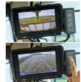
Al conducir hacia adelante, puede ver el nivel de llenado del vehículo acompañante con la cámara situada en el canal de descarga. Al circular hacia atrás, la imagen cambia automáticamente a la cámara de marcha atrás.
