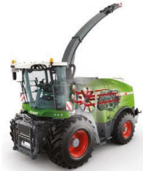
El ventilador variable no aspira más aire del necesario. Esto libera o ahorra capacidad de reserva en función de la tarea y los requerimientos de potencia, lo cual aumenta notablemente la eficiencia general de la Fendt Katana. Gracias a la función de inversión del ventilador, la suciedad se expulsa del radiador a intervalos ajustables modificando el flujo de aire. El radiador trabaja siempre a plena capacidad de refrigeración y los intervalos de limpieza son más prolongados.
