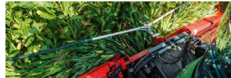
El cabezal de maíz está disponible en 8, 10 o 12 hileras. Al conducir por carretera, el cabezal se pliega hidráulicamente para poder colocarlo rápidamente en la posición de transporte.
