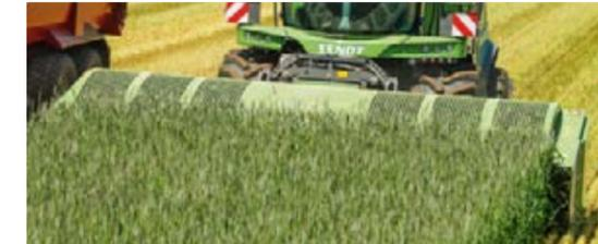
El resistente mecanismo de cabezal de corte directo está diseñado para cortes profundos sin pérdidas en todos los tipos de cultivos. En la cosecha de la biomasa, se produce el mejor ensilado con una mínimo porcentaje de suciedad.
