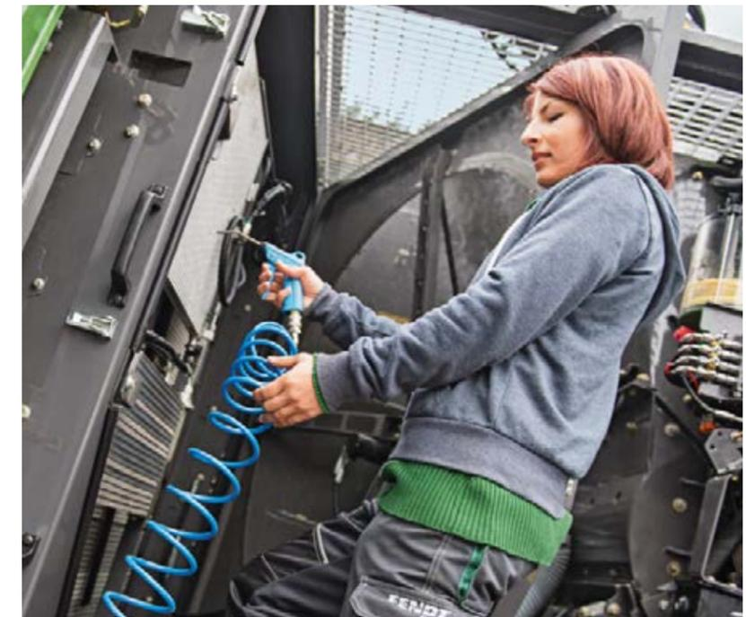
Los componentes de la Katana son especialmente fáciles de acceder gracias a las grandes capós de mantenimiento, que se abren hacia arriba, no de lado. El paquete de iluminación de mantenimiento marca la diferencia en la oscuridad.
