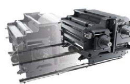
El sumamente eficiente cracker R con perfil de dientes de sierra no deja escapar ningún grano. Gracias al amplio espacio de procesamiento entre los grandes rodillos y una diferencia de velocidad del 30% o 40% entre los dos rodillos del acondicionador, ofrece excelentes resultados de despulpado.
