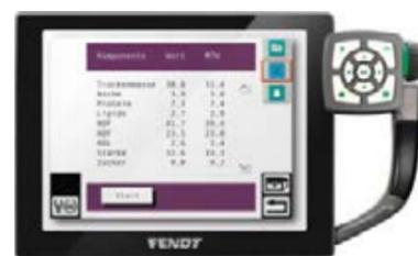
Ejemplo de uso del control de aperos Variotronic en la pantalla de un sensor NIR compatible con ISOBUS.
