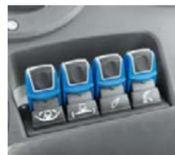
Funciones como la apertura/cierre del cabezal de maíz y las ruedas de soporte del pick-up, la inclinación del cabezal y la subida/bajada del canal de descarga se controlan fácilmente con los interruptores basculantes.
