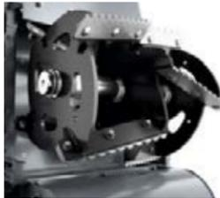
El soplador de descarga de la nueva Fendt Katana es como un rotor abierto con elementos de descarga en V. Puede equiparse con paletas lisas o dentadas, según los requerimientos.
