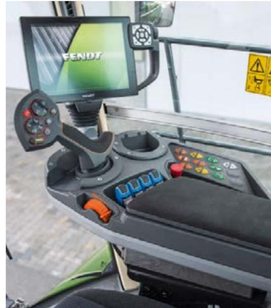
El apreciado reposabrazos derecho, muy popular entre los conductores de tractores Fendt, ha sido adaptado y adoptado para la picadora.
