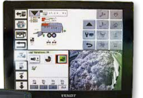
La función TIM se activa a través del terminal Vario y funciona cuando el control de cruce está activo.
