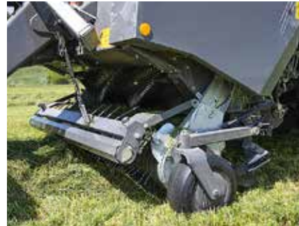
El pick-up tiene una anchura de 2,20 m. Las ruedas palpadoras laterales y un rodillo trasero se encargan de la adaptación al terreno. Fotografías: Berning
