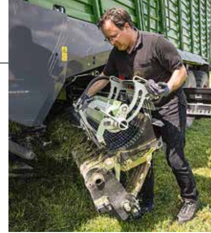
El dispositivo de afilado siempre viaja en el remolque y se coloca en cada una de las diez cuchillas para afilarlas.
