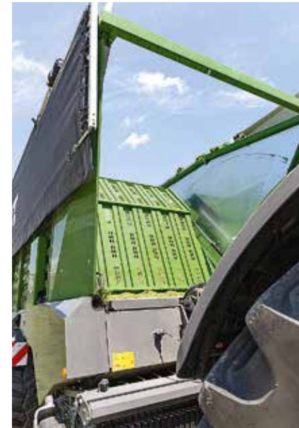
Un sensor de presión en los cilindros de la pared frontal abatible controla el proceso de carga y establece la precompresión.
