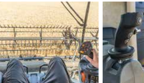
El joystick dispone de los controles para los intermitentes. En la parte delantera se ubican los controles para las luces, el sistema de autoguiado y la bocina.
