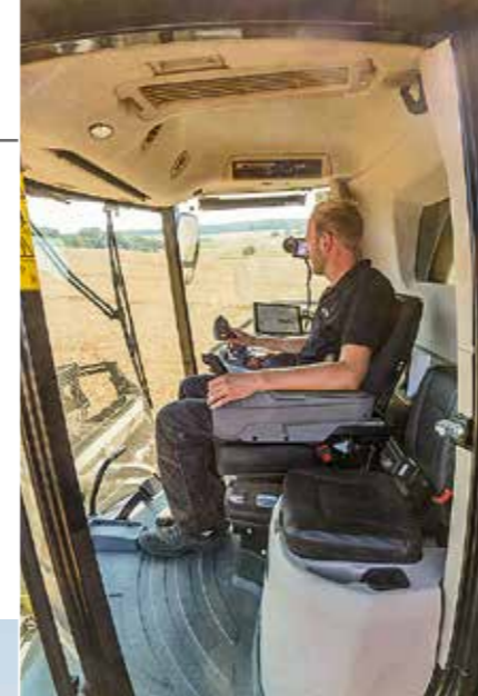
Dirección sin el molesto volante: El sistema de guiado Idealdrive prescinde del volante y en su lugar incorpora un joystick que se maneja con la mano izquierda.
