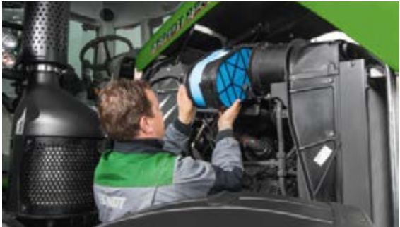
El filtro de aire se retira de forma rápida y sencilla.
