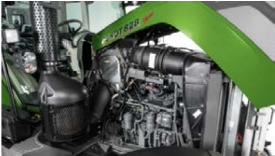
El capó abatible y los paneles laterales fácilmente extraíbles ofrecen un excelente acceso al compartimiento del motor.
