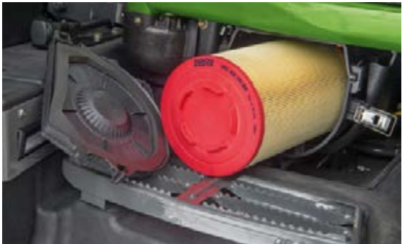
El filtro de la cabina es fácilmente accesible desde la zona de la puerta y puede limpiarse con rapidez en caso necesario.
