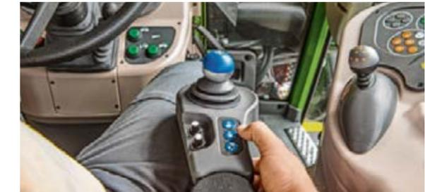
En las cabeceras o durante los trabajos con el cargador frontal puede beneficiarse de la dirección VarioActive, alcanzando el ángulo total de giro de las ruedas con un solo giro del volante. El sistema de dirección superpuesta no tiene límites hasta 8 km/h, mientras que el efecto de superposición es lineal entre 8 y 18km/h.
