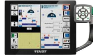
El terminal Vario y el ordenador de trabajo del cargador frontal están conectados a través del zócalo CargoProfi.
