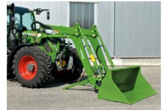
El Fendt Cargo-Lock garantiza un montaje y desmontaje rápido y sencillo. Un multiacoplador conecta todos los conductos hidráulicos y eléctricos al mismo tiempo, incluso con presión en el lado del cargador frontal.
