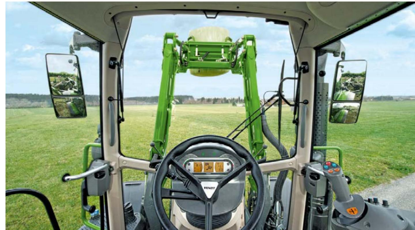
El exclusivo parabrisas curvo del tractor le permite tener siempre una visión perfecta de los aperos totalmente extendidos. Al mismo tiempo, su curvatura evita que se acumule material en el parabrisas y mantiene una visión completamente despejada.
