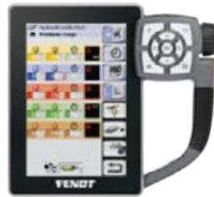
El terminal Vario permite realizar ajustes precisos en las funciones de las válvulas con pantalla táctil y pulsadores. Por ejemplo, puede controlar el caudal de forma sencilla y precisa usando los mandos giratorios y los pulsadores de función.
