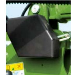
Dos sensores de presión de la viga transversal permiten activar la función de pesaje del CargoProfi.
