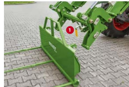
El apero se desbloquea cómodamente utilizando una palanca (1) situada en el bastidor de acoplamiento rápido, con solo el movimiento de una mano. Cuando se monta un accesorio, puede bloquearlo automáticamente volteándolo hacia atrás por completo.
