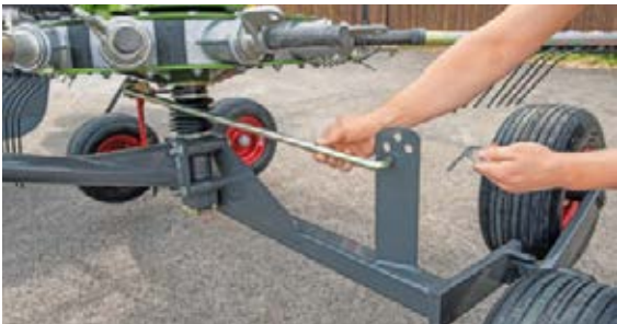
Tanto si el forraje es largo y pesado como si es corto y ligero, la pista de leva se ajusta fácilmente para adaptarse a las condiciones de recolección.
