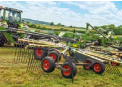
Al descender en las cabeceras, primero tocan el terreno las ruedas traseras y después las delanteras. En las elevaciones, los rotores se elevan primero por la parte delantera. Este Jet-Effect protege la cubierta vegetal.
