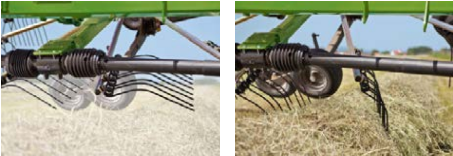
A la izquierda puede ver las púas que se elevan con CamControl. El sorprendente despeje al suelo protege la hilera. La imagen de la derecha muestra un sistema convencional que ha dejado dañada la hilera.
