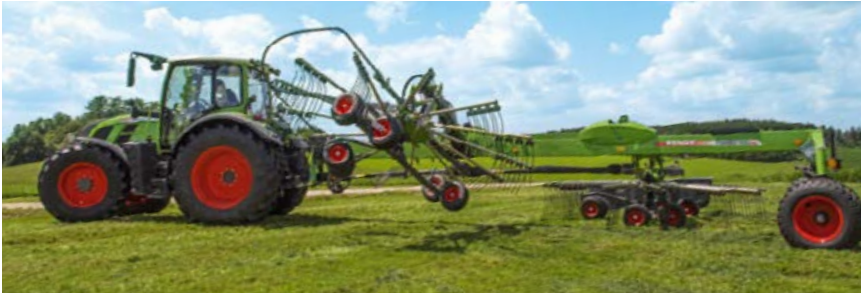
El control secuencial siempre eleva el rotor del rastrillo hilerador Fendt Former en la cabecera por el orden idóneo.
