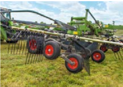
Al descender en las cabeceras, primero tocan el terreno las ruedas traseras y después las delanteras. En las elevaciones, los rotores se elevan primero por la parte delantera. Este Jet-Effect protege la cubierta vegetal.
