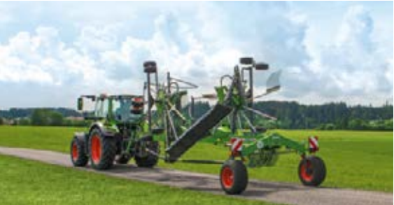
El rastrillo de hilerado lateral de dos rotores Fendt Former también se puede transportar por carretera de forma rápida y segura, y plegarse formando una unidad compacta.
