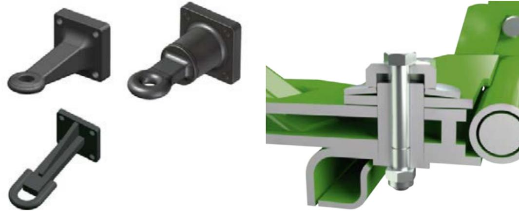
□ Independientemente de si se trata de la argolla o del gancho de una barra de tiro rígida o pivotante, el Fendt Twister siempre le brinda la opción adecuada. (Fendt Twister 11008 T y 13010 T)
