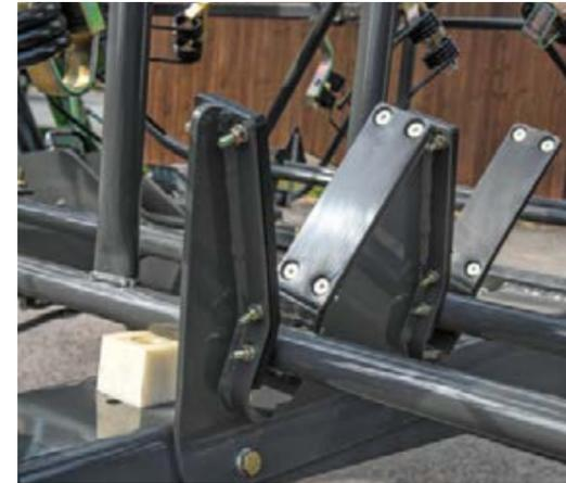
■ Los estribos protectores del Twister, equipados con rodamientos de larga duración, encajan a la perfección en los soportes especiales con forma de V del bastidor. (Solo en la versión con chasis del Fendt Twister).
