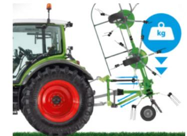
El sistema patentado de compresión de tracción garantiza un óptimo seguimiento del terreno y un magnífico comportamiento de remolque gracias al punto de enganche bajo.
