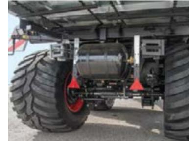
Todos los modelos pueden equiparse opcionalmente con la dirección forzada hidráulica o electrónica. El diseño de barra de tiro eficiente e inteligente también permite un ángulo de giro de 60° incluso con dirección forzada.
