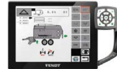
Con la función TIM ready, el Tigo XR puede ajustar la velocidad del tractor según la carga de cultivo en la hilera y la capacidad del pick-up.
