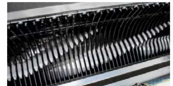
El rotor, con un diámetro de 800 mm y 7 filas de púas en espiral de acero Hardox, está equipado en ambos lados con grandes rodamientos de rodillos esféricos.
