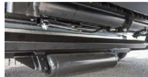
El rodillo palpador, ubicado centralmente detrás del pick up, mantiene continuamente el despeje ajustado al suelo y garantiza un guiado seguro del pick-up incluso en condiciones difíciles de terreno.
