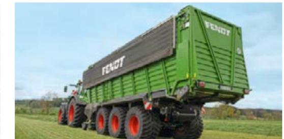
La cubierta hidráulica del espacio de carga se maneja fácilmente a través del terminal.
