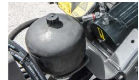
La suspensión de la barra de tiro de enganche del Fendt Tigo le proporciona una mayor comodidad de conducción.
