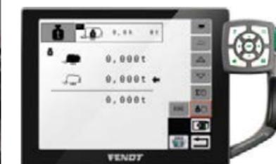
El sistema de pesaje integrado de forma opcional en la suspensión hidroneumática del chasis le muestra el rendimiento del cultivo cómodamente en su cabina. Esto le permite mantener un control constante del peso y la carga útil.
