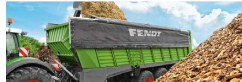
El Fendt Tigo ha sido diseñado sin bastidor tubular para permitir un llenado sencillo desde arriba, ya se utilice un cargador o picador.
