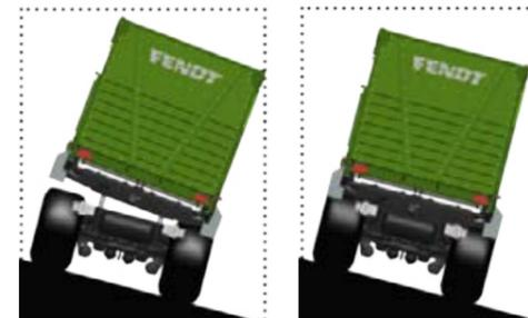
Sin el control de nivelación automática, el vehículo se inclina hacia abajo o hacia un lado en pendientes dependiendo de la carga y la velocidad en giros (véase la Figura izquierda). Con el control de nivelación automática del FSC, el vehículo se mantiene siempre paralelo a la pendiente. El vehículo se ajusta siempre a la mejor altura del chasis en función de la carga (véase la Fig. derecha).
