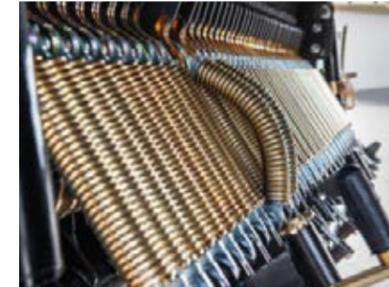
El bastidor de corte está subdividido en dos grupos para poder cambiar fácilmente entre una longitud de corte de 45 mm, 90 mm o sin cortar.
