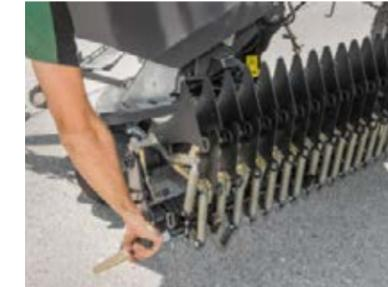
El bastidor de corte abierto reduce los trabajos de mantenimiento y limpieza, ya que la geometría abierta del bastidor permite que lo atraviese todo tipo de suciedad hasta llegar al suelo.
