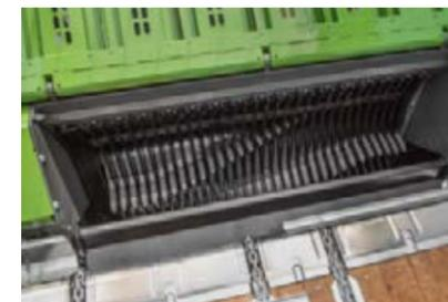
El rotor de 800 mm de diámetro y seis filas de dientes en espiral de acero Hardox está equipado en ambos lados con grandes rodamientos de rodillos esféricos.
