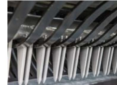
El brazo oscilante transportador de sección única permite un flujo de material suave y uniforme.
