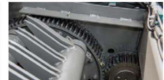
La unidad de brazo oscilante es accionada mediante engranajes de bajo desgaste con unos engranajes rectos sumamente resistentes.
