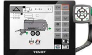
Controle la mampara y el bastidor de corte del Tigo MR Profí directamente a través del terminal. Desde aquí también puede ajustar de forma cómoda el pick-up y la barra de tiro de enganche.
