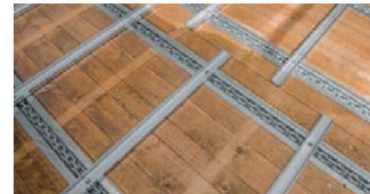
Con las cuatro cadenas de acero redondo de 10 mm de grosor de los grandes modelos Tigo MS, MR y todos los MR Profi, con una carga de rotura de 50 Tn., estará preparado para las aplicaciones más exigentes. Los modelos pequeños Tigo MS y MR le ayudan con dos cadenas del suelo transportador y una carga de rotura de 25 Tn. También puede optar por equipar los modelos más pequeños con cuatro cadenas y barras rascadoras alternas.
