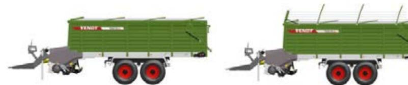
La unidad de forraje seco abatible se pliega y despliega desde la cabina. Por lo tanto, puede circular sin ningún problema y ampliar rápidamente el espacio de carga para la recolección de heno.
