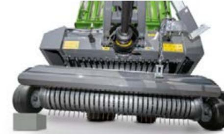
Las ruedas de control posteriores del pick-up automático lo liberan en curvas, pueden girar y proteger así la cubierta vegetal. Es posible ajustar la altura de las ruedas mediante una serie de agujeros.
