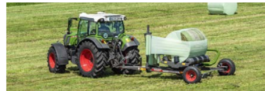
La Fendt Rollector encinta balas con un diámetro de entre 0,90 m y 1,30 m.
