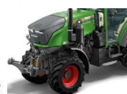
El depósito de combustible de 68 litros u 83 litros (opcional) en el pilar A garantiza una larga autonomía y un sencillo repostaje. Después está el depósito de AdBlue de 16 litros en la parte delantera del capó. Puede trabajar durante más tiempo sin repostar.
