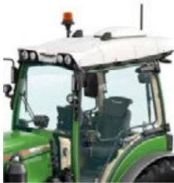
El receptor Fendt Guide está bien protegido e integrado en el diseño del techo.
