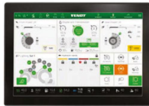
**Terminal táctil de 12" – funciones adicionales, superficie de pantalla y control táctil**
