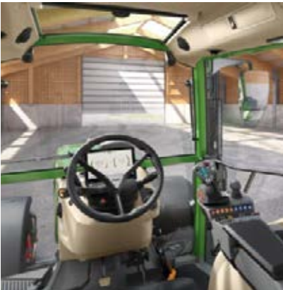
Profi Setting 1 - Palanca monomando en cruz - 2 módulos lineales (par de interruptores basculantes) para manejar las válvulas hidráulicas
