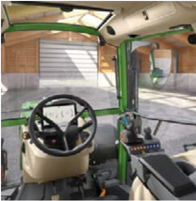
Power Setting 2 - Palanca monomando en cruz - Sin módulo lineal (par de interruptores basculantes)
