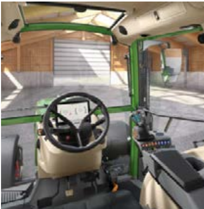
Power Setting 1 - Sin palanca monomando en cruz - 2 módulos lineales (par de interruptores basculantes) para manejar las válvulas hidráulicas
