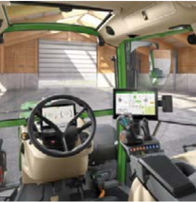
Profi+ Setting 2 - Joystick 3L - 2 módulos lineales (par de interruptores basculantes) para manejar las válvulas hidráulicas - Terminal de 12"
