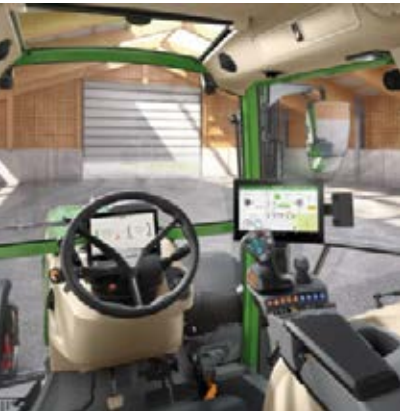
Profi+ Setting 1 - Palanca monomando en cruz - 2 módulos lineales (par de interruptores basculantes) para manejar las válvulas hidráulicas - Terminal de 12"
