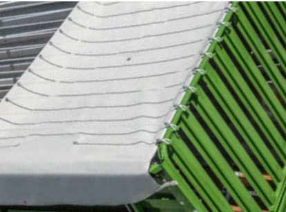
Lisävarusteena saatava suojapeiteverho edessä pitää rehun turvallisesti kuormaustilassa.
