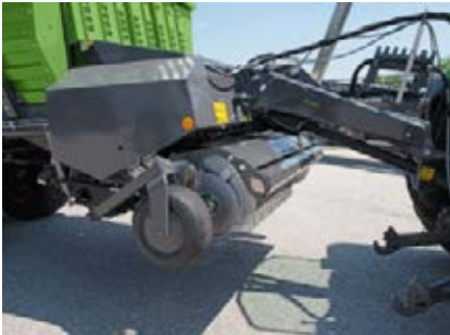
Tigo S:n liikkumisvara on jopa 70 cm hydraulisen nivelöidyn vetoaisan ansiosta.
