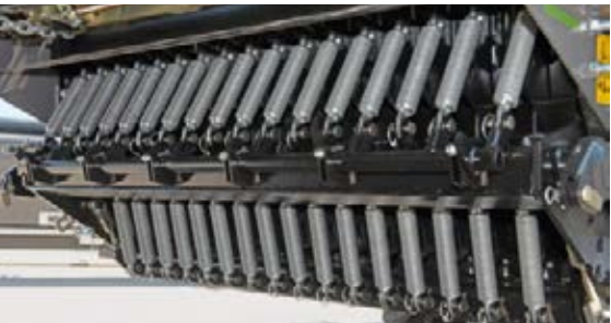
Valinnaisesti leikkuriyksikkö voidaan kääntää hydraulisesti työasennosta huoltotilaan.
