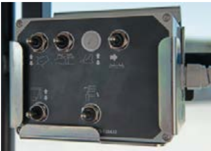
Sähkömagneettiset pikahallintalaitteet tarjoavat kaikki tarvittavat toiminnot kuljettajan istuimelta.
