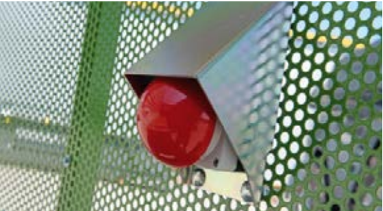
Takaseinässä oleva täyttöasteanturi ohjaa lisävarusteena saatavaa tason ääni-ilmaisinta.
