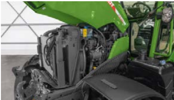
Moottoritila on erittäin hyvin ulottuvilla tarkastusta ja huoltoa varten, myös etukuormajalla varustettuna. Kaksiosainen konepeitto on helppo avata.
